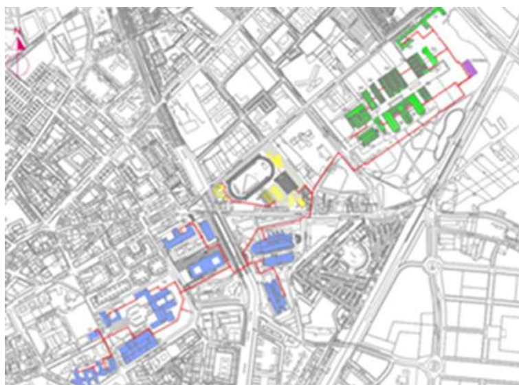
Imagen 8: sistema de calefacción urbana por biomasa para todos los centros del Campus de Valladolid
